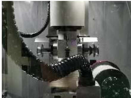
高刚性床身，经应力消除 为高效磨削建立基础
